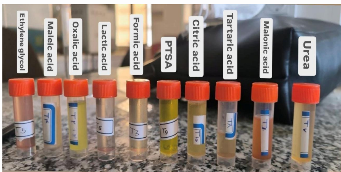
شکل ۱. بازیابی آهن و مجموعه حلال‌های یوتکتیک عمیق DESs تهیه‌شده از کولین کلراید و ۱۰ ترکیب HBD مختلف بر اساس نسبت مولی ۱:۱ مورد استفاده در آزمون لیچینگ NdFeB.
